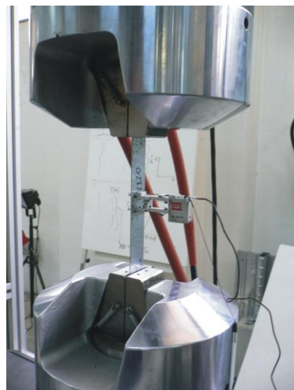
Images 4 et 5. Essais en éprouvette pour obtenir la résistance caractéristique du béton et la limite élastique de l'acier
