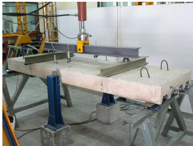
Image 6. Essai pour obtenir les paramètres m-k du plancher collaborant
