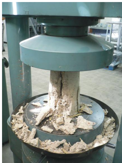
Images 4 et 5. Essais en éprouvette pour obtenir la résistance caractéristique du béton et la limite élastique de l'acier
