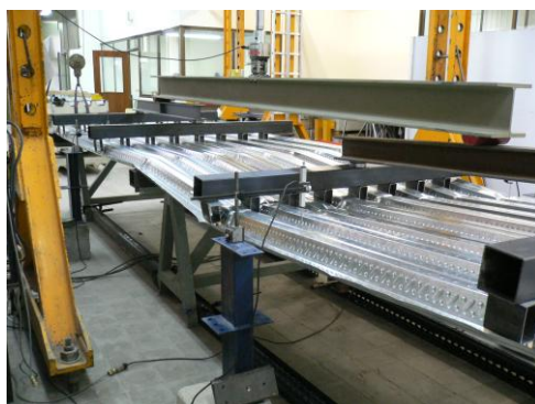
Images 2 et 3. Essais pour l'obtention des moments d'inertie et des modules résistants du profil
